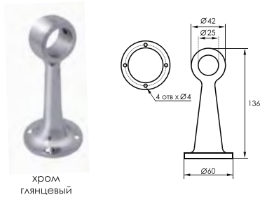
R-50AR Держатель дистанционный регулируемый торцевой d-25
